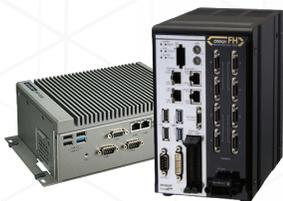
Les contrôleurs Vision offrent la puissance et la flexibilité d'un système basé sur PC traditionnel, mais résistent mieux aux environnements de fabrication difficiles. Les contrôleurs Vision facilitent la configuration d'applications multi-caméras 2D et 3D et sont configurés pour effectuer des tâches de protocole industriel avec leurs ports E/S. Cela permet à des applications sophistiquées d'être configurées de manière plus rentable.
