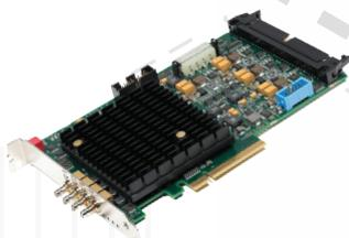
Les cartes d'acquisition sont utilisés pour intégrer des acquisitions rapides et flexibles, et des applications de traitement. Ils travaillent avec des caméras industrielles à grande vitesse telles que Camera Link, CoaXPress et Serial Digital Interface. Avec des cartes d'acquisition, un projet industriel peut capturer des données avec un détail exceptionnel, permettant à l'utilisateur de travailler sur des projets de haute précision avec confiance et précision.
